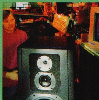
Das MILSSA-Testverfahren jedes einzelnen Lautsprechers ist die letzte einer Reihe von strengen Qualitätsprüfungen. Jamo kombiniert realistische Klangtests mit den präzisen Messungen in neuester Technologie bei der Erfassung der Lautsprechereigenschaften.
