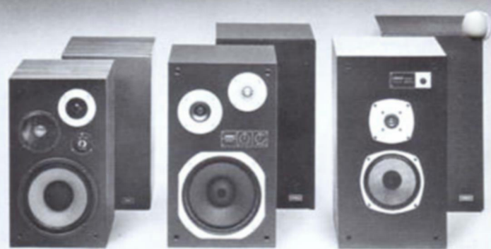
HS-335 HiFi 3-Weg-Box Musikbelastbarkeit 50 W Bruttovol. 38 \angle Frequenzumfang 35-20 kHz
