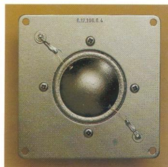
Früher: Anschlußblitzen außen, durch Berührungsgefahr Litzenbruch möglich.
