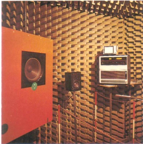
Akustikmessungen im „Schalltoten Raum“
