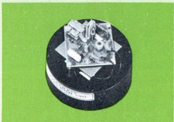
Alle Bauteile einschließlich der Blitzröhre werden auf eine Leiterplatte montiert.
