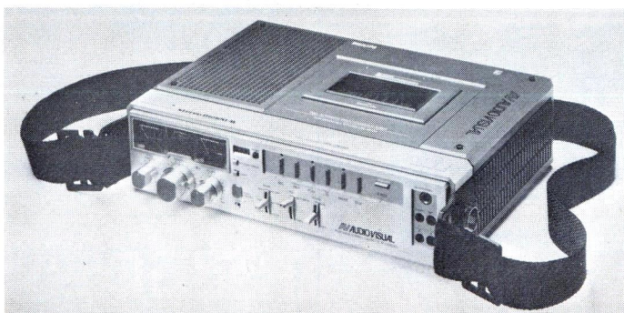
Philips D 6920 AV , Stereo-Cassettenrecorder für die Film- und Dia-Vertonung, mikroprozessorgesteuertes 3-Motoren-Laufwerk für höchste Ganggenauigkeit. Automatische und manuelle Aufnahmemöglichkeit, Post-Fading-Einrichtung, Überblendmöglichkeit in bestehenden Tonaufnahmen, Intermix-Bedienung mit Cue/Review. Automatische Bandendabschaltung, Netz/Batterie. 598.-
