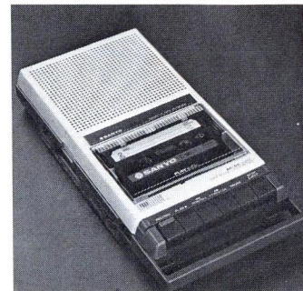
Sanyo Slim-3 , Slim-Line-Recorder, Such- und Repetierschnell-Lauf während Wiedergabe (Cue/Review). Eingebautes Mikrofon, automatische Aufnahmeaussteuerung, Pausetaste, Autostop, Netz/Batterie. 119.-
