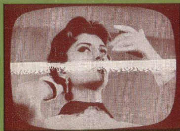
Diathermie-Störungen und Störungen von HF-Geräten
