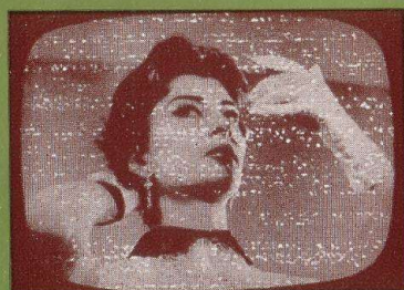
Funkenstörungen von Autos, Motoren, Kühlschränken, Klingeln und Trockenrasierapparaten
