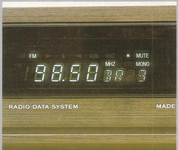
Radio-Daten auf Schmalspur-Display: Der Programmname wird vierstellig angezeigt – bei Bedarf im Durchlaufbetrieb
