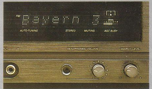
Wohlförmige Buchstaben und Ziffern dank Dot-Matrix: Der T-9000 kann die RDS-Informationen im Klartext anzeigen
