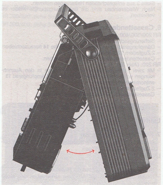
Abb. 3b RR 220 Gehäuserahmen aus dem Gehäuse-Vorderteil ausbauen
