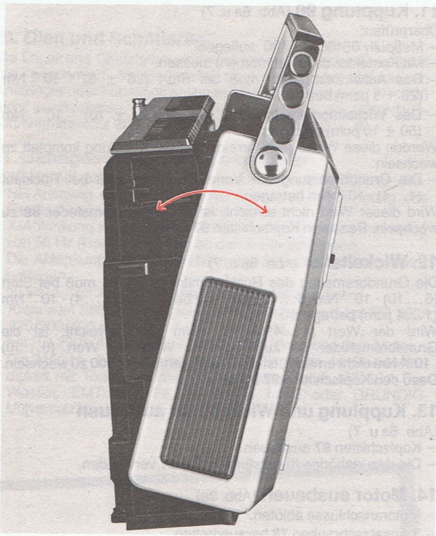
Abb. 2b Gehäuserahmen aus dem Gehäuse-Vorderteil ausbauen
