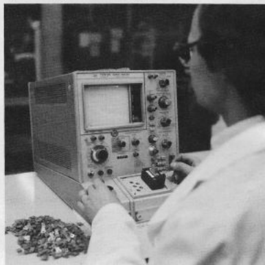
Bild 23 Eine 100 %-ige Kontrolle von Transistoren durch einen Mitarbeiter der Qualitätssicherung im Wareneingang
