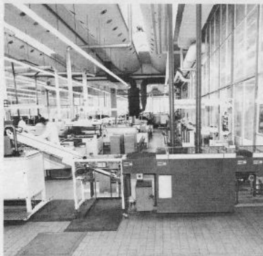
Bild 10 Verketteter Übergang zwischen Ätzmaschine und Lötstopdruck
