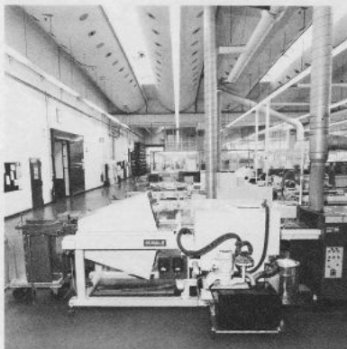
Bild 12 Beizen und Schützen im Durchlaufsystem
