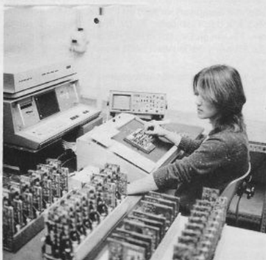
Bild 24 Mikroprozessor-gesteuerte Prüfautomaten verfolgen die fertigen Platinen bis zu ihrer Montage im Gerät
