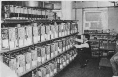
Bild 26 Die „Folterkammer“ des MO 53 – der Dauertest und seine ständige Überwachung
