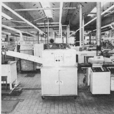
Bild 11 Wendestation für Leiterplatten zwischen Lötstopdruck und Montage- druck
