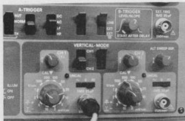
Bild 6 Die beiden Vertikaleingänge mit ihren Bedienelementen
