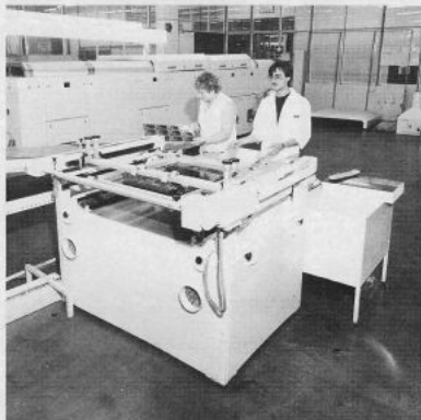
Bild 3 Ätzresistdruck mit Hilfe eines Siebdruckhalbautomaten
