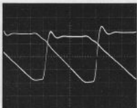
Spannung an den Actuatoren (280 Vss)
