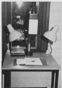
Bild 6 Titelkamerateisch mit Beleuchtungs- anordnung
