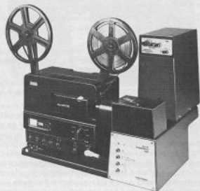
Bild 1 Gesamtansicht des elektronischen Filmabstasters EFA 8/1000 von Grundig für 18- und 24 Bilder/s
