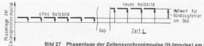
Bild 27 Phasenlage der Zeilensynchronimpulse (H-Impulse) am Gap
