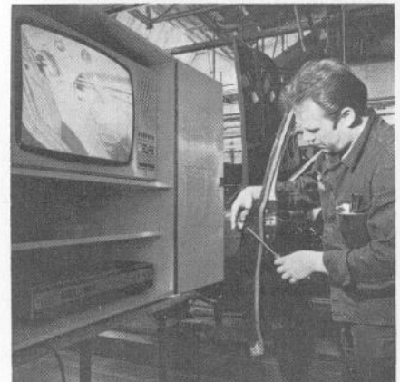
Bild 8 Die Unterweisungsstationen im Pilotwerk sind in fahrbaren Schränken untergebracht, so daß der günstigste Sichtwinkel für die Unterweisung gewählt werden kann.
