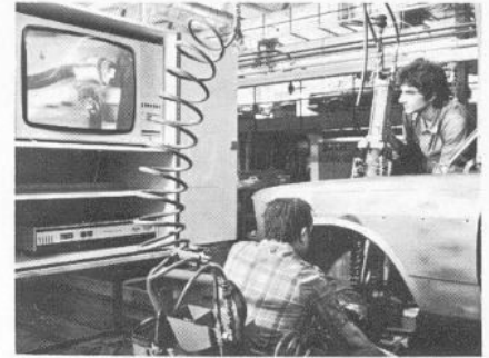
Bild 10 „Eingelernte“ Mitarbeiter überzeugen sich anhand der Aufzeichnung von der Richtigkeit ihrer Arbeitsdurchführung, hier bei der Vorderachsmontage.
