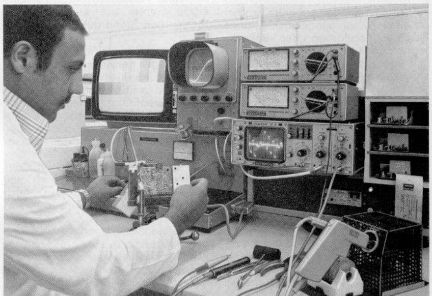
Bild 2 Reparaturplatz mit Kugelgelenkadapter (Farbbaustein)
