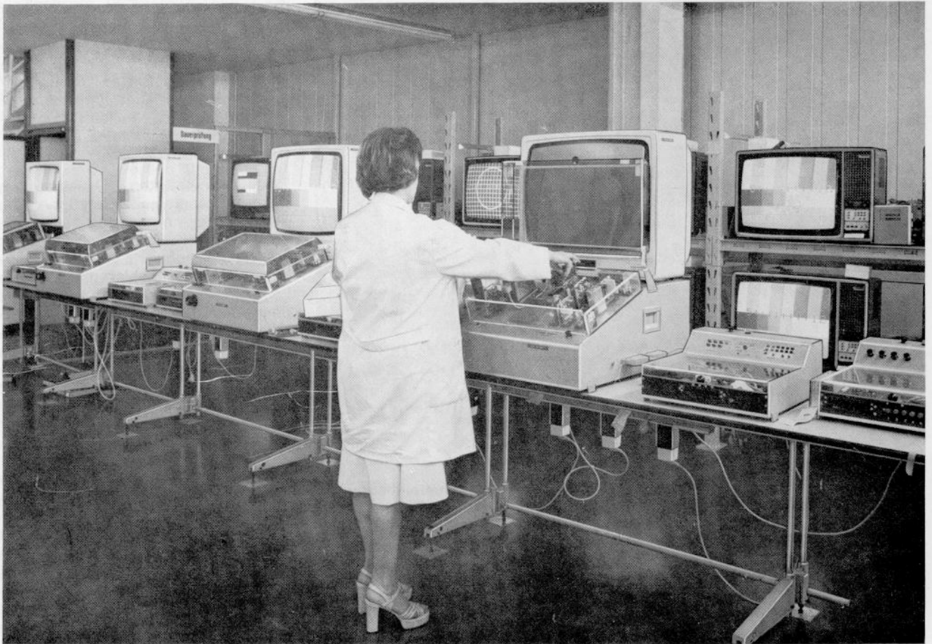
Bild 5 Dauerprüfanlage für Module mit Langzeitfehlern
