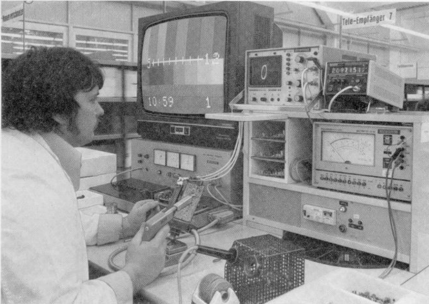
Bild 3 Reparaturplatz Uhrbaustein (Heizeinschub in Bildmitte)
