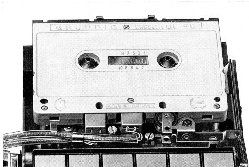
Bild 1 Kassette im Gerät bei gedrückter Starttaste. Köpfe und Andruckrolle sind in die Aussparungen der Kassette geschoben
