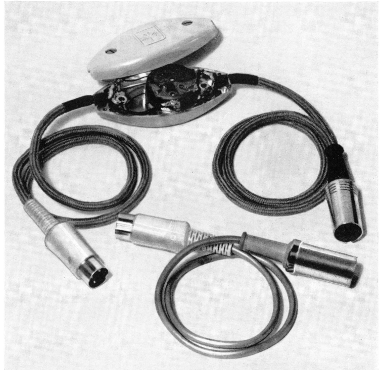
Bild 1 Oben: Das bisherige Mikrofon-Verlängerungskabel mit Schnurübertrager darunter: Das neue Mikrofon-Verlängerungskabel mit Stecker-Übertrager
