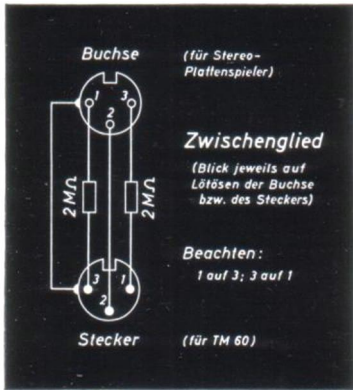
Bild 5 Schaltung des Zwischengliedes
