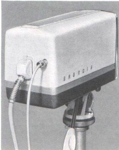
Bild 2 Die Kabelanschlüsse beim FA 40
