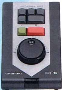
Video-Mouse 'Fun'. Zentrales Eingabe- und Bedienelement für den Video-Schnittplatz. Mit Jog-Shuttle-Rad, Tasten zur Player- und Recordersteuerung und zur Festlegung von Szenenanfang und -ende.
