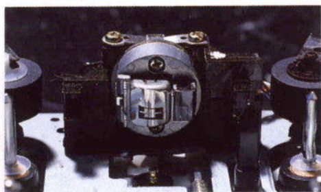
Rotating heads für beste Azimut-einstellung.
