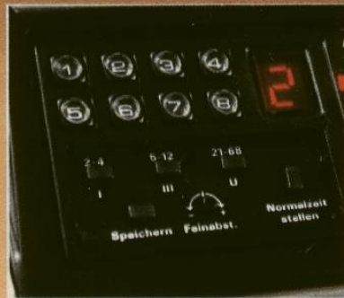
8 Electronic-Tipptasten zum Abruf vorprogrammierter Sender im UHF- oder VHF-Bereich. Unten: Bedienelemente für Sendersuchlauf, Speicherung und Normalzeit.
