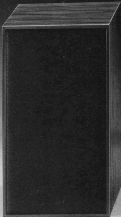
GRUNDIG HiFi-Box 306 Regalbox in Zweiweg-Technik, ca. 40 × 22 × 21 cm, mit einem Tiefton- und einem Kalotten-Hochton-System. 35/25 Watt Musik-/Nennbelastbarkeit, Frequenzbereich 40...26000 Hertz, HiFi nach DIN 45500, Gehäuse nußbaumfarben oder weiß.
