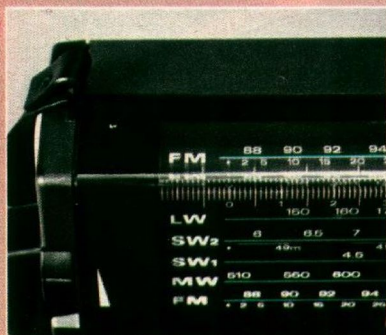
Signal 700: 1. Abstimmanzeige-Instrument, auf Batteriekontrolle umschaltbar. 2. Alle Anschlüsse sind durch Schiebeklappe abdeckbar und somit spritzwassergeschützt. 3. Die Winkelskala mit doppelter Anzeige des UKW-Bereichs (frontal und von oben).
