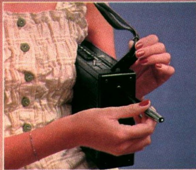
Abnehmen des Tragegurt bei Signal 500 und 700: Kugelschreiber in seitliches Loch drücken. Gurt herausziehen.
