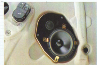
Montagerahmen MR 3 mit L 403-T und L 401-W als Türlautsprecher im Ford Mondeo.
