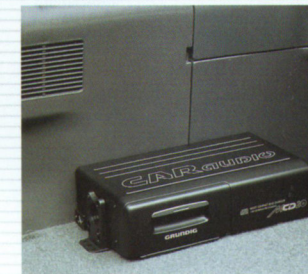
Der MCD-20 kann in vertikaler oder horizontaler Position im Kofferraum installiert werden.
