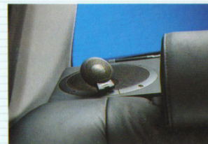
Mit den Montagerahmen MR 1 und MR 2 können LU 1600 MTS und LU 1620 HiFi auf die Heckablage der BMW 5er und 7er Reihe montiert werden.
