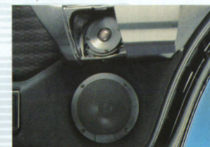
L 401-W und L 400-T: Türeinbau hinten im Mercedes 200-300 T, Modellreihe W 124.
