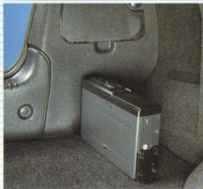
Neben der horizontalen und vertikalen ist auch die 45°-Einbaulage beim MCD-30 möglich.
