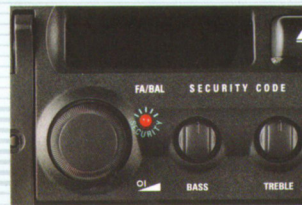
Die Blink-LED bei ausgeschaltetem Gerät zeigt ungeliebten Interessenten an: Autoradio kodiert.
