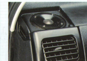
L 400-T: Armaturenbretteinbau im VW Golf III.
