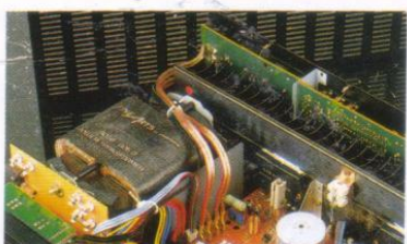
Der Ausgangsleistung entsprechende, großdimensionierte Leitungsführung.
