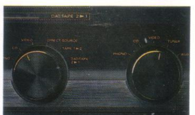
Cross-Mode: Beim Hören einer Signalquelle ist die Aufnahme einer anderen möglich.
