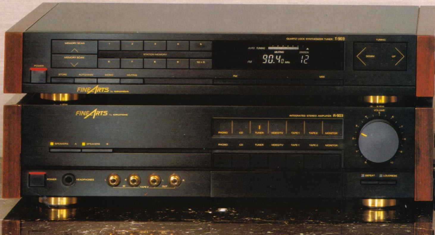
Oben: Regler/Schalter unter Alu-Klappe (Taste Tuner gedrückt). Unten: Rauschminimierung durch doppelte Lautstärke-regelung.
