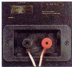
Großdimensionierte Schraubklemmen für Kabelanschluß.
