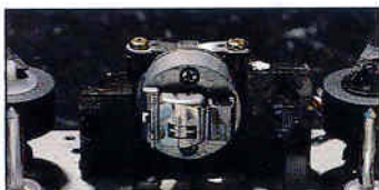
Rotating heads für beste Azimuteinstellung.
