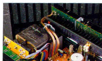
Der Ausgangsleistung entsprechende, großdimensionierte Leitungsführung.
