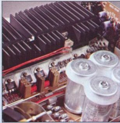
Übersichtlicher Chassisaufbau mit Endstufen-Transistoren, großflächigen Kühlrippen, Thermo-Schalter und Netzteil-Elkos
