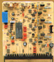
Compact-Universal-Chassis eines Grundig Stereo-Farbfemsehgerätes mit seinen Steckkarten
