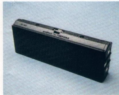
Dryfit-Accu 476 Für Satellit 3400/2400/1400. Aufladbarer Kleinaccu, der anstelle der Monozellen eingesetzt werden kann. Spannungsreserven für ca. 25–30 Stunden.
