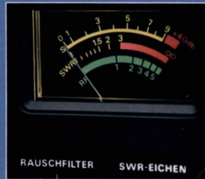
Anzeige-Instrument für relative Feldstärke, HF-Ausgangsleistung und Stehwellenverhältnis
