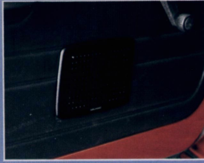
Einbaulautsprecher L/U 19 Grill = ca. 165 x 110 x 15 mm; zusätzlich 46 mm für Einbautiefe erforderlich.
