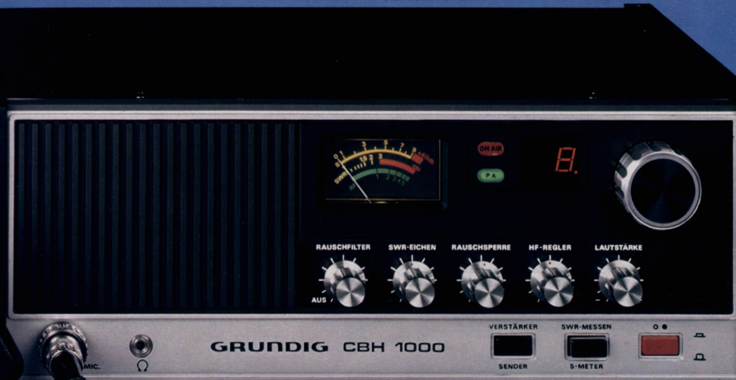
Anzeige-Instrument für relative Feldstärke, HF-Ausgangsleistung und Stehwellenverhältnis
