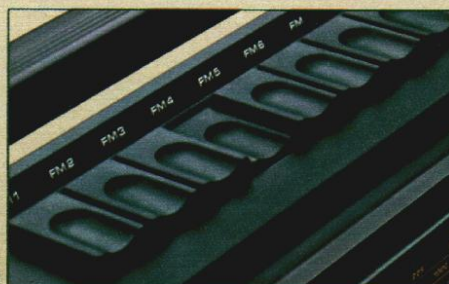
1. LCD-Frequenzanzeige und Grob-/Feintrieb zur exakten Senderabstimmung. 2. Sechs UKW-Programmtasten – festprogrammierbar.
