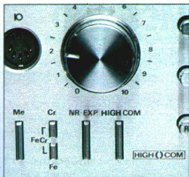
4fach-Bandselector mit Reineisenband-Einstellung, NR-Expander und das äußerst wirksame High Com-Rauschunterdrückungs-System sind charakteristische Merkmale.
