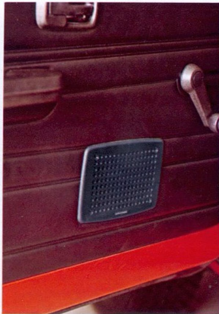
Einbaulautsprecher L/U 19 und L/U 23 (L/U 23 ohne Abbildung) Nennbelastbarkeit 5 W Musikbelastbarkeit 7 W Übertragungsbereich 75... 12500 Hz Grill L/U 19 = ca. 165 × 110 × 5 mm; zusätzlich 46 mm für Einbautiefe erforderlich. Grill L/U 23 = ca. 112 × 112 × 5 mm; zusätzlich 48 mm für Einbautiefe erforderlich.
