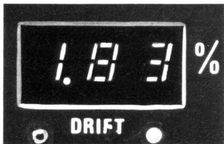
Digitale Driftanzeige Keine Nullpunktkorrektur erforderlich
