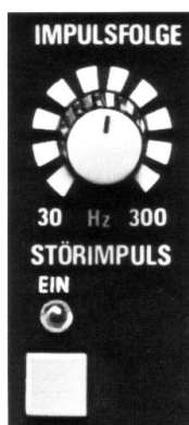
Störimpuls zur Prüfung der elektronischen Störaustattung (ESA)
