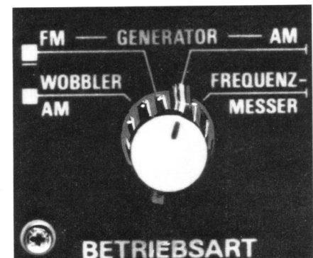
Vier Betriebsarten: AM-Generator FM-Generator Wobbler (fünf Wobbelbereiche) Frequenzmesser bis 200 MHz
