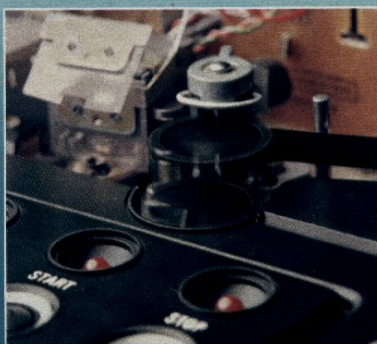
Schlitzfreies Einlegen des Tonbandes durch versenkbare Andruckrolle und hochschwenkende Kopfabschirmung.
