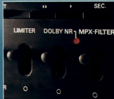
Das ist der Bedienungskomfort: Limiter, Dolby-NR-System und MPX-Filter sind jeweils zuschaltbar.
