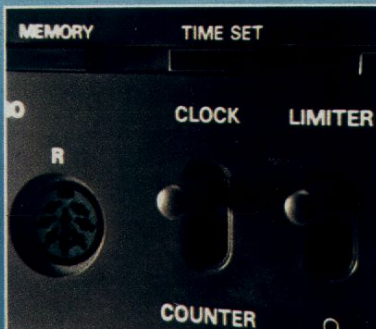
In Stellung „Counter“ wird die Zeitanzeige zum elektronischen Bandlängenzähler.
