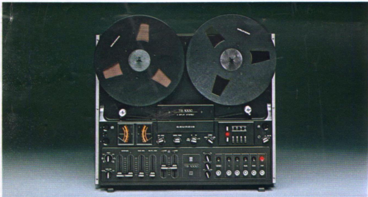
TS 1000 3-Motoren-HiFi-Tape-Deck mit Steuerlogik für die Laufwerkfunktionen. Bandgeschwindigkeiten 4,76; 9,5 u. 19 cm/s. Zusätzlich variable Band- und Umspulgeschwindigkeit. Hallgenerator-Motor für Tonwellenantrieb. Auswechselbare Kopfräger. Vorwählzähler. Aufnahme-Automatic, manuelle Aussteuerung oder Limiter-Betrieb. Stereo-Mischpult. Kopfhörer-Endstufen. Übertragungsbereich 20 . . . 20 000 Hz bei 19 cm/s. Geräuschspannungsabstand 66 dB bzw. 74 dB mit Dolby-NR bei Halbspur und 19 cm/s. Lieferbar sofort.
