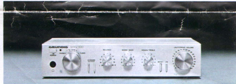
MXV 100 HiFi-Vorverstärker zum Ansteuern von Aktiv-Boxen oder Endstufen. Nenn-Ausgangsspannung 1 V/Ri 200 Ω. Übertragungsbereich 5 . . . 60 000 Hz-3 dB, 20 . . . 20 000 Hz-0,5 dB. Anschlüsse für Tuner, TA-Magnet, 2 Tonband- oder Cassettengeräte, Monitor, Stereo-Kopfhörer, Line-Ausgang, Contour-/Linear-Schalter, Lautsprecher-Gruppenschalter. 2-stufiger Empfindlichkeitsschalter für TA-Magnet, max. Übersteuerungsfestigkeit bei TA: 200 mV. Einschaltspannung für MA 100. Lieferbar ca. Oktober 1979.
