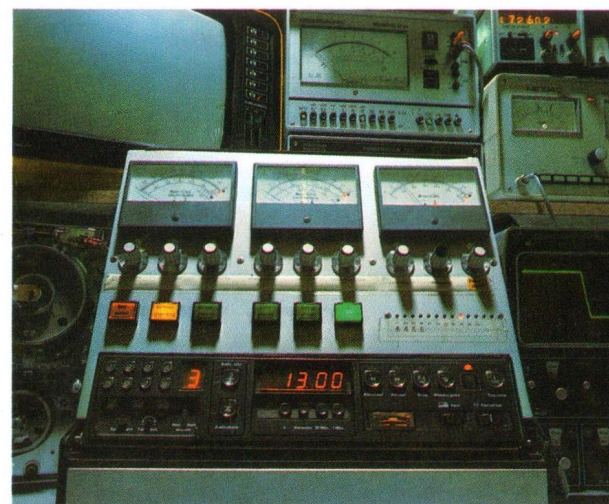
Adaptierung des Laufwerks auf elektrische und mechanische Grenzwerte.
