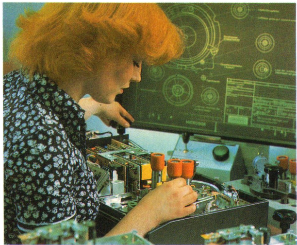
Die mechanische Justage des Laufwerks.
