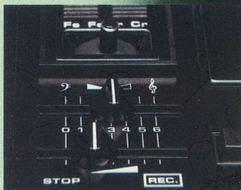
Enkel betjäning av volymkontroll med skjutreglage. Bandsortväljare för tre bandtyper. Start instrument för batterikontroll.
