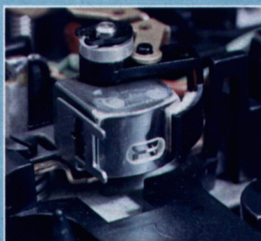
Automatische Kopfreinigung: Beseitigt bei jeder Start/Stop-Bedienung Ablagerungen am Kopfspiegel
