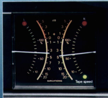
Echte Spitzenwertanzeige. Leuchtdioden für Spurwahl und zur Anzeige bei Erreichen der Sollgeschwindigkeit.
