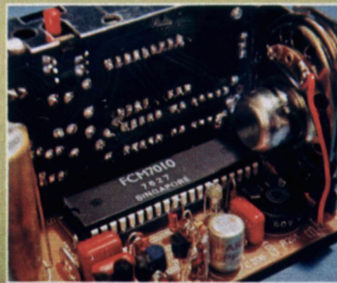
Uhrenmodul in IC-Technik wie EC 10
