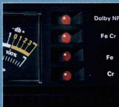
Übersichtliches Signal-Anzeigendeck mit Leuchtdioden für Dolby-NR, Ferrochrom-, Eisenoxid- und Chromdioxid-Cassetten.
