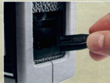
Die Batterie-/Netzumschaltung erfolgt automatisch, wenn Sie das Netzkabel an das Gerät anschließen.
