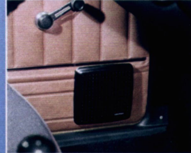
Einbaulautsprecher L/U 21 Grill = ca. 142 x 142 x 18 mm; zusätzlich 37 mm für Einbautiefe erforderlich.
