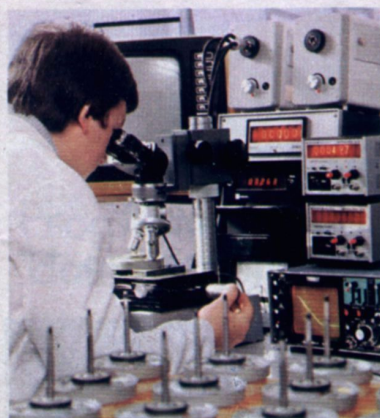
Vermessung des Herzstücks der Maschine – Kopfrad und Videoköpfe.
