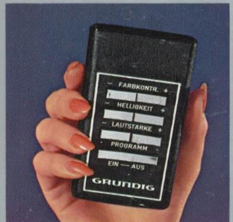
„tele-dirigent“ drahtlose Fernsteuerung
