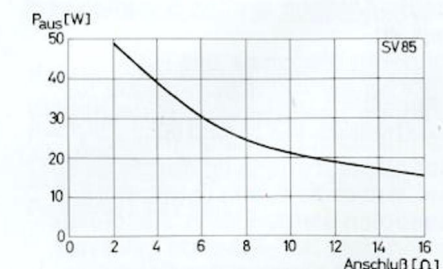
Ausgangsleistung in Abhängigkeit von der Abschlußimpedanz beim SV 85
