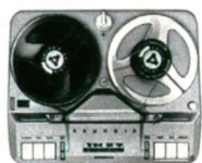
TM 19 Mono-Halbspur 9,5 cm/s. Abmessungen ca. 34 x 15 x 27 cm
