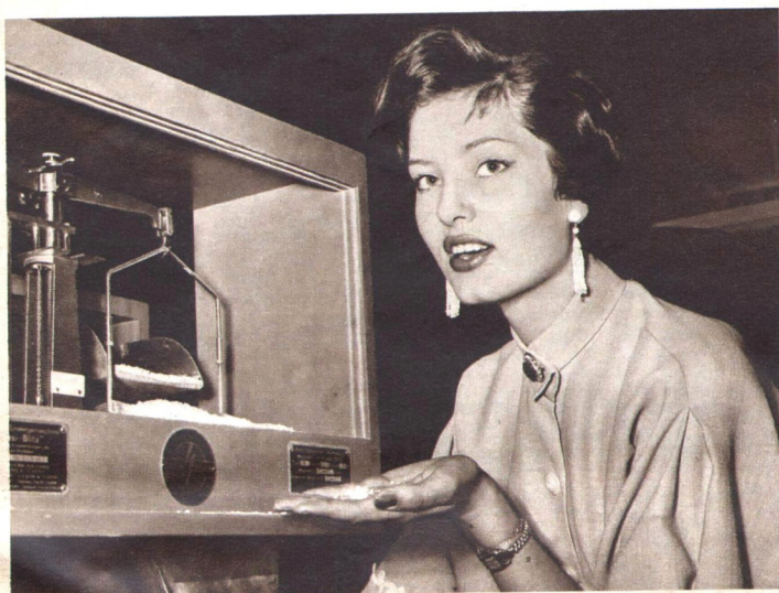
Glasklare Spulenträger und viele andere Konstruktionsteile in jeder gewünschten Farbe entstehen aus diesem körnigen milchweißen Rohstoff, dem Kunststoff Polystyrol, den Gabriele hier an der Waage für die Beschickungsanlage (oben) der riesigen Pressen durch die Finger rinnen läßt. Unter Druck und Hitze wird der Stoff verformt, kleine Bauelemente werden in mehreren Stücken zugleich gespritzt.
