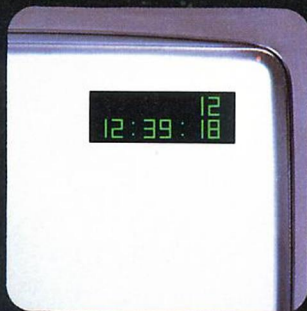
Digital-Programmanzeige. Quarzgesteuerte Digital-Uhrzeit im Bildschirm.
