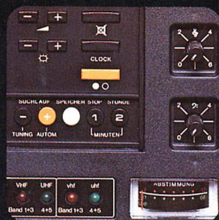
JKG »SSL-System«. Automatischer Digital-Sendersuchlauf mit elektronischer Speicherung für 20 Programme und AFC-Feinabstimmung.
