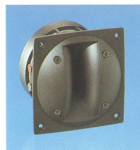
T-850 Tweeter PA-D* Imp.: 8Ω fr.: 2.5-19kHz SPL: 105±2dB Pwr.,max: 100W min. Xov.: 4kHz weight: 2250g
