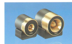
T-500A Tweeter M-Hifi* Imp.: 8Ω fr.: 2-25kHz SPL: 102±2dB Pwr.,max: 50W min. Xov.: 5kHz weight: 4700g
