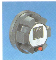
FD-60 1" Driver PA-D-M* Imp.: 8Ω fr.: 1-16kHz SPL: 105±2dB Pwr.,max: 50W min. Xov.: 1.2kHz weight: 3800g
