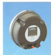
FD-200 2" Driver PA-D-M-Hifi* Imp.: 8Ω fr.: 500Hz-10kHz SPL: 106±2dB Pwr.,max: 80W min. Xov.: 700Hz weight: 6200g
