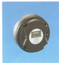
FD-40 1" Driver PA* Imp.: 8Ω fr.: 1-16kHz SPL: 104.5±2dB Pwr.,max: 50W min. Xov.: 1.5kHz weight: 2400g
