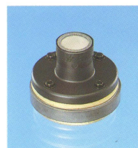
FD-25 1" Driver PA* Imp.: 8Ω fr.: 1-20kHz SPL: 104±2dB Pwr.,max: 40W min. Xov.: 3kHz weight: 800g
