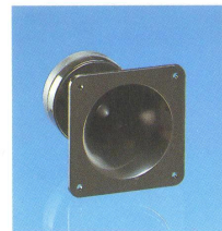
FH-27 Tweeter PA* Imp.: 8Ω fr.: 4-15kHz SPL: 107±2dB Pwr.,max: 50W min. Xov.: 5kHz weight: 860g
