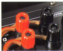
Hohe Verstärkerleistungen erfordern verlustarme Kabel mit hohem Querschnitt. Massive Anschlußklemmen sorgen für sicheren Kontakt und geringsten Übergangswiderstand.
