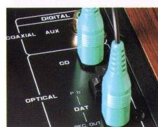
Für Aufnahme und Wiedergabe digitaler Programmquellen stehen zusätzlich koaxiale und optische Digitaleingänge für Glasfaser-Lichtleiter bereit.
