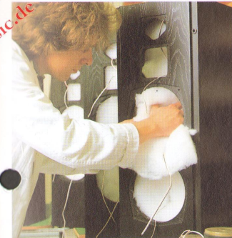
Einlegen des Dämmmaterials
