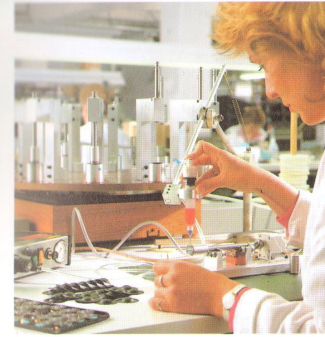
Verkleben der Hochtonspulen mit den Kalotten
