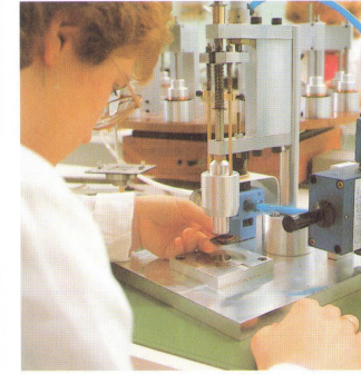
Einbau der Kalotten mit den Spulen in die Montageplatte
