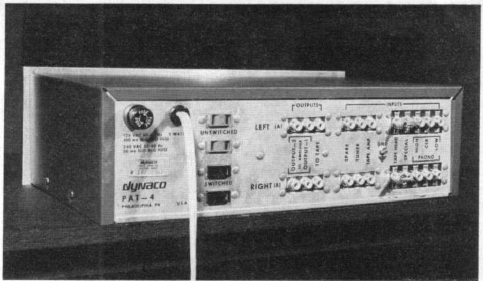
Die Rückseite des PAT-4: Alle Ein- und Ausgänge sind in Cynch-Buchsen ausgeführt. Neben vier amerikanischen Steckdosen und Ausgängen für den Kraftverstärker findet sich auch ein von allen Reglern unabhängiger Ausgang für den Anschluß einer Tonbandmaschine
