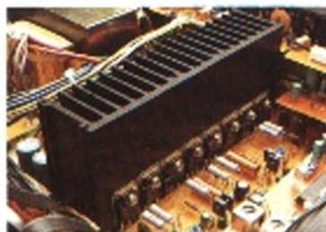
Dual CR 5950 RC: NutMüger mit 5 (Koppel-)transistorierten Endstufen.
