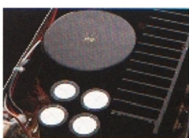
Spezieller High Power-Ringkern-Transformator des Dual CV 5670.
