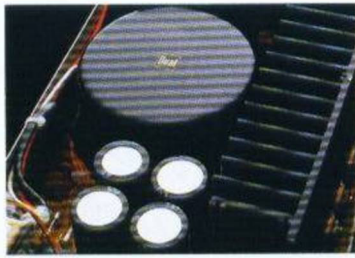
Spezieller High Power-Ringkern-Transformator des Dual CV 5670.
