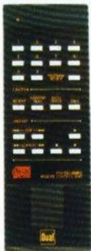
Die Infrarot-Fernsteuerung Dual RC 105 wird beim CD-Spieler Dual CD 1050 RC als Standardzubehör mitgeliefert.
