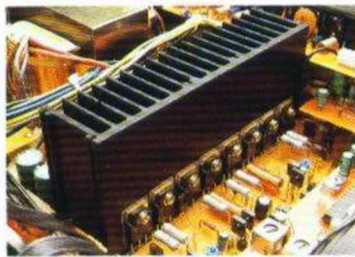
Dual CR 5950 RC: Kühlkörper mit 8 (doppel-)transistorisierten Endstufen.
