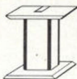
Fußelement Vario Tech F 200 Höhe: 360 mm
