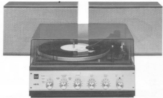
Dual HS 33 Stereo-Heimanlage (Kompakt-System) mit Automatikspieler Dual 1210 (Wechselauswahl) für Schallplatten aller Größen und Arten. 2 x vierstufiger 6 Watt Stereo-Transistor-Verstärker. Eingangswahlschalter für Phono, Tuner und Tonbandgerät. Zwei 6 Watt Breitband-Lautsprecherboxen. Netzspannungen 110/130, 150, 220/240 Volt Wechselstrom. Gehäuse: Nußbaum natur mit Metall-Profilblende Maße (Steuergerät mit Abdeckhaube): 356 x 195 x 320 mm, Gewicht: 8,0 kg. Maße (Lautsprecherboxen): je 195 x 300 x 130 mm, Gewicht: je 1,5 kg
